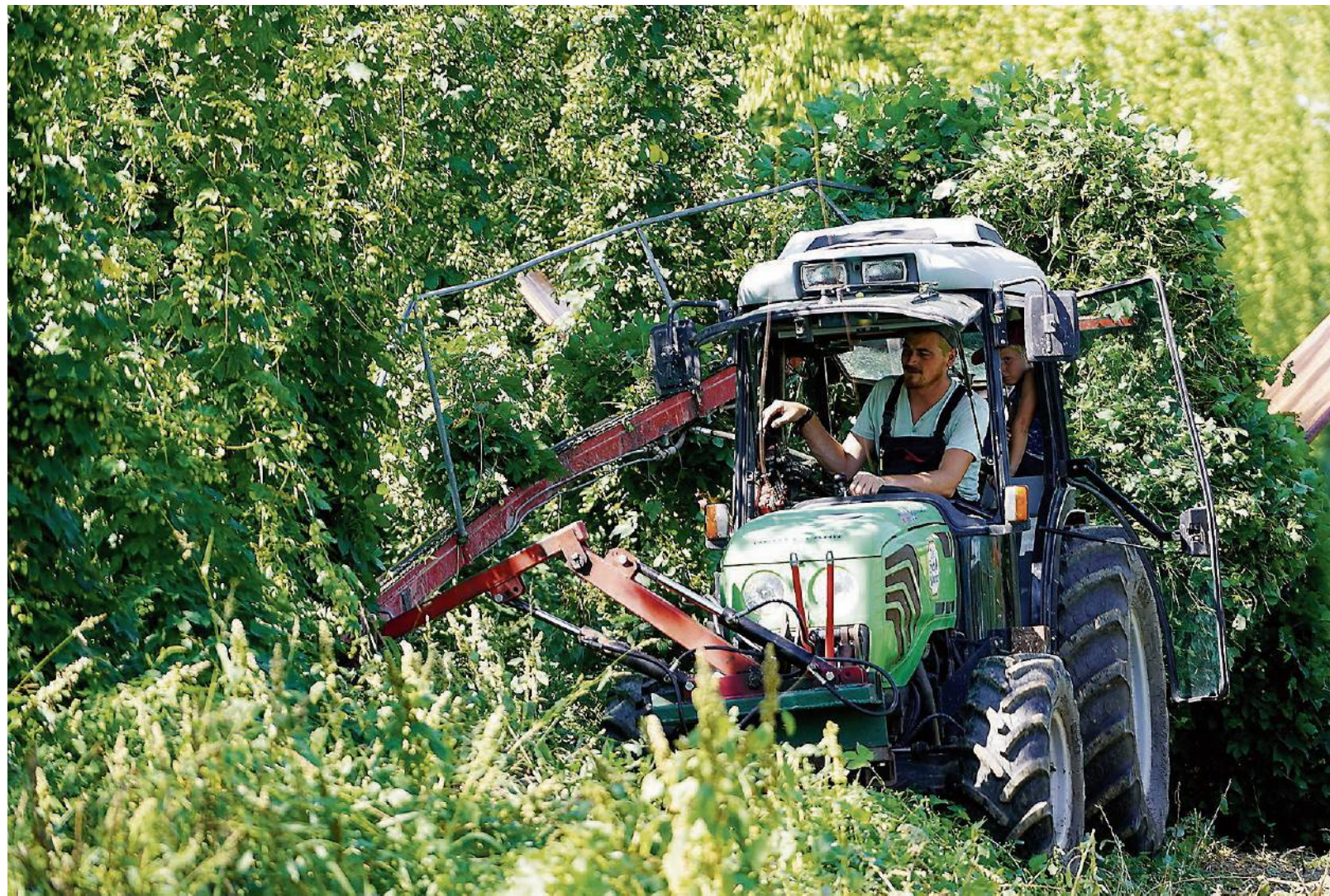
Mit einem Reißgerät werden die Pflanzen im Hopfengarten von der Leine gerissen. Dann fallen sie auf einen Anhänger.
